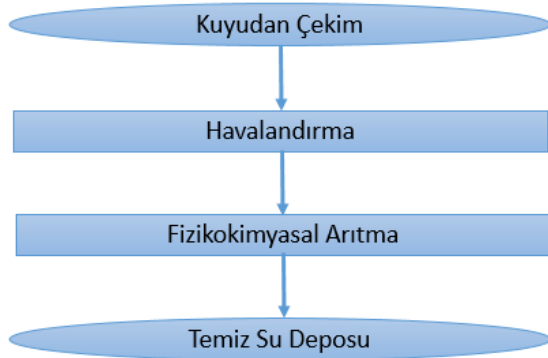
Şekil 7.2 Kısmi anaerobik yeraltı suları arıtımı.
