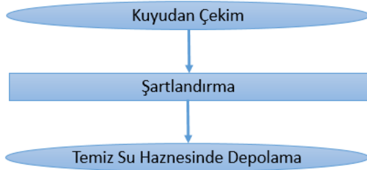
Şekil 7.1 Aerobik yeraltı suyunun arıtma adımları.
