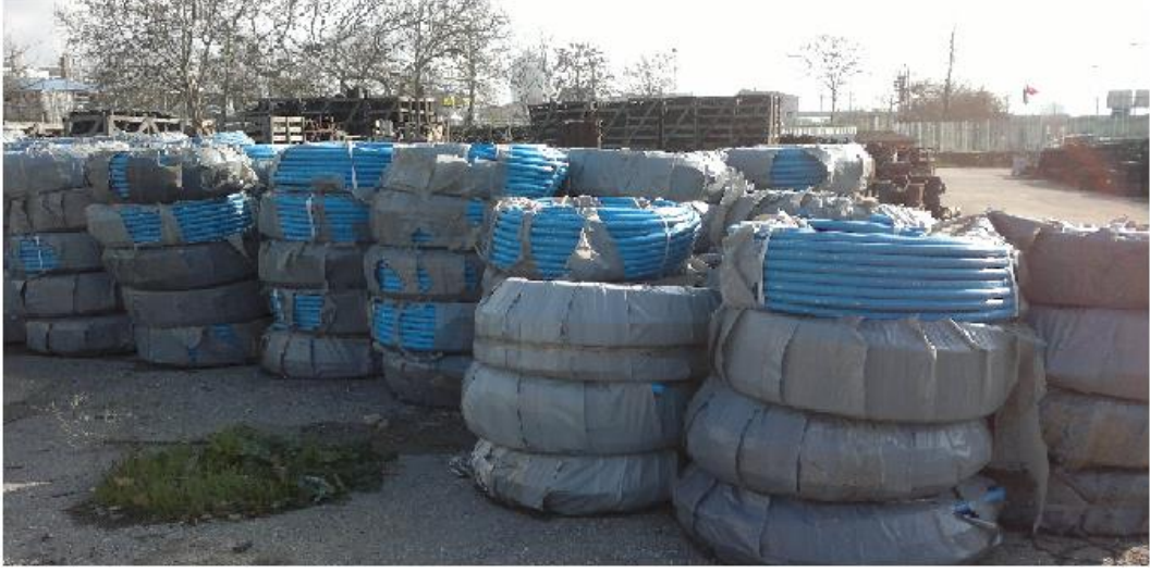
Şekil 21. UV ışınlarına maruz kalan hatalı depolanmış PE borular
