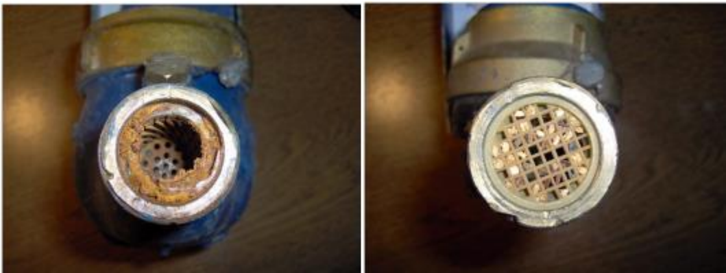
Şekil 83. Sayaç filtresinde oluşan tıkanmalar
