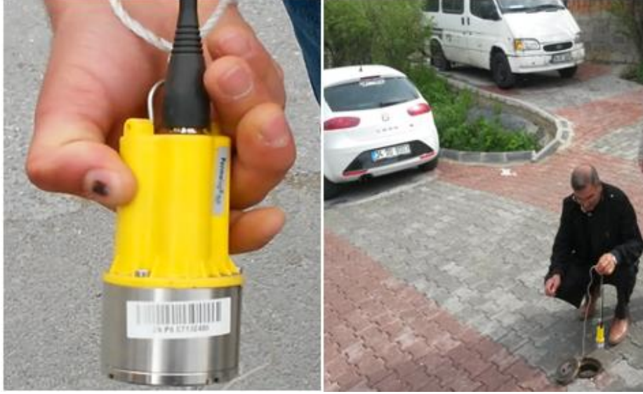
Şekil 102.Permalog ses kaydedici sistem
