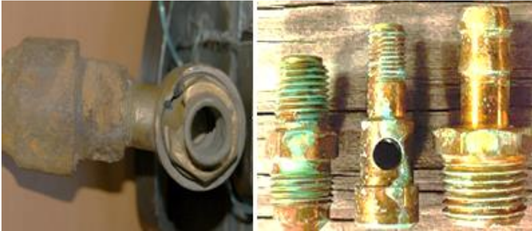
řekil 48. Dezinsifikasyon sebebiyle bazı blgelerinin yeřil renk aldıđı pirin malzemeler
