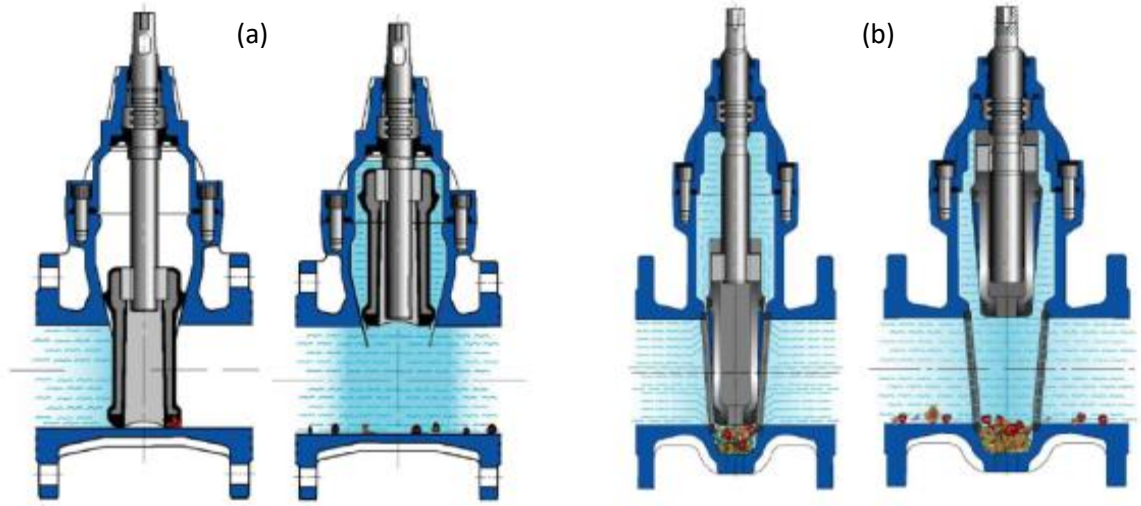
Şekil 60. Elastomer sitli ve metal sitli vana mukayesesi (AVK, 2016)
