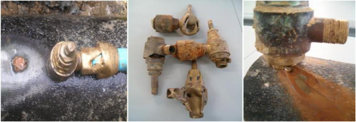
Şekil 116. Hasar görmüş ana musluklar ve kelepçesiz ana musluk bağlantısı
