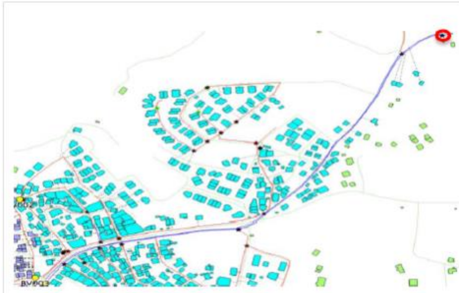
Şekil 127. DMA bölgesinde bulunan kritik basınç noktası (İSKİ, 2014)
