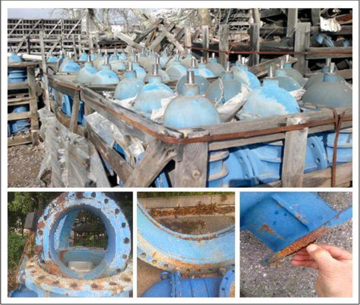
Şekil 24. Boyası tahrip olmuş, kullanılmamış altyapı malzemeleri
