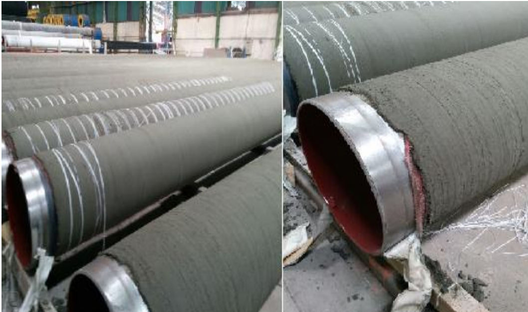
Şekil 28. Boru iç yüzeyinin kaplanması
