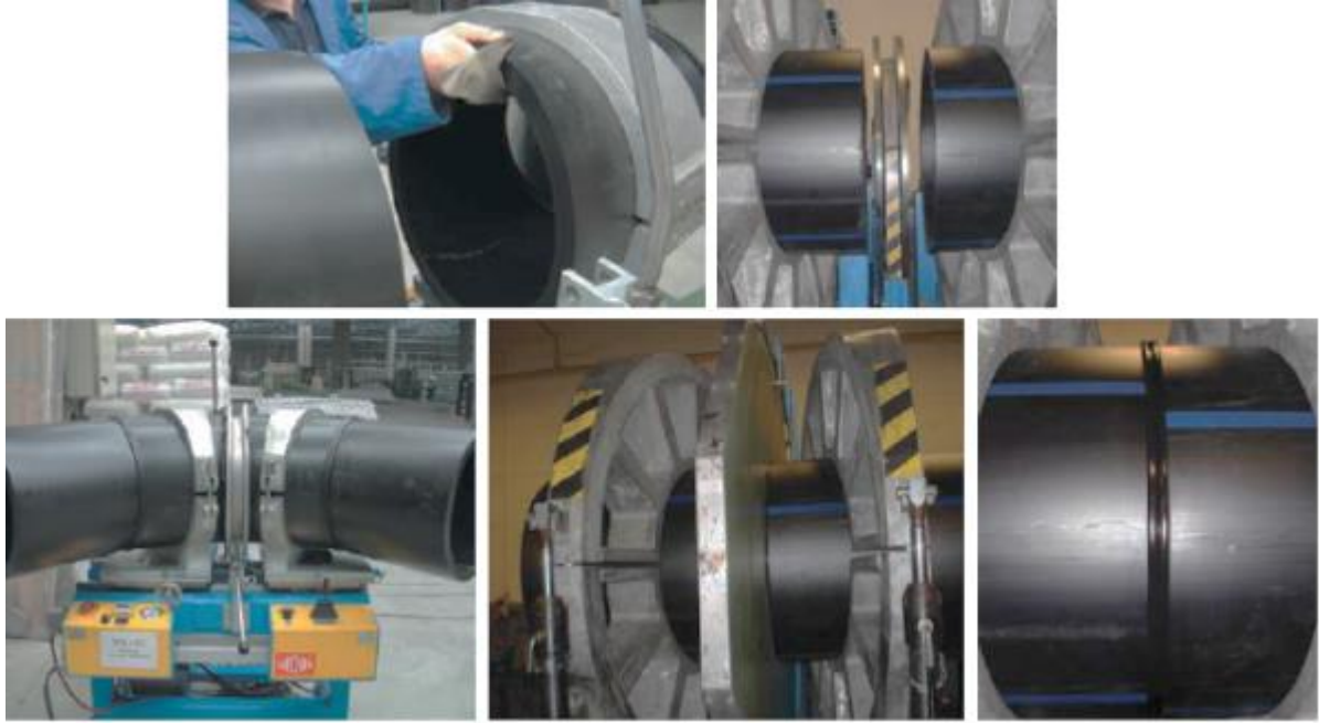
Şekil 47. Alın kaynağı ve uygulaması (Fırat Plastik, 2016)
