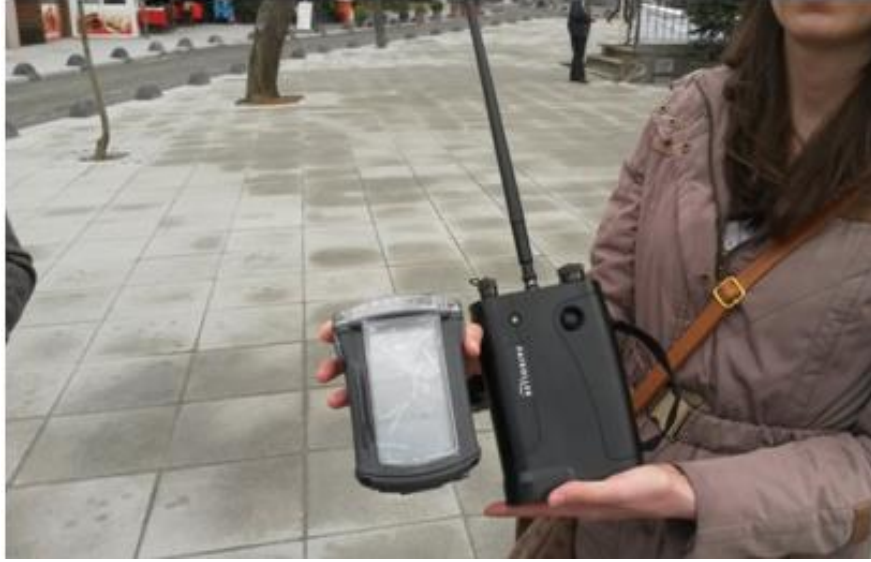
Şekil 104. Permalog sistem saha uygulaması-2 (El Terminali)
