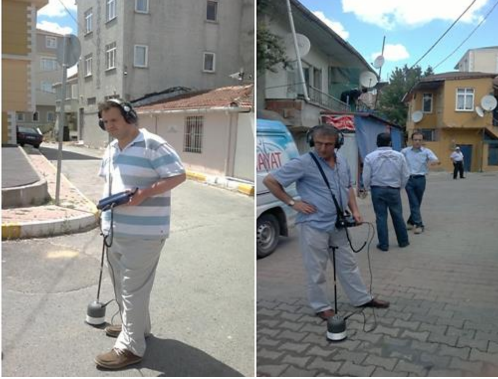
Şekil 97. Yer mikrofoni arazi uygulamaları
