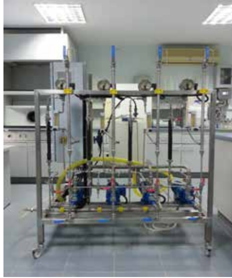
Şekil 3. Hızlı Küçük Ölçekli Granüler Aktif Karbon Test Düzeneği
