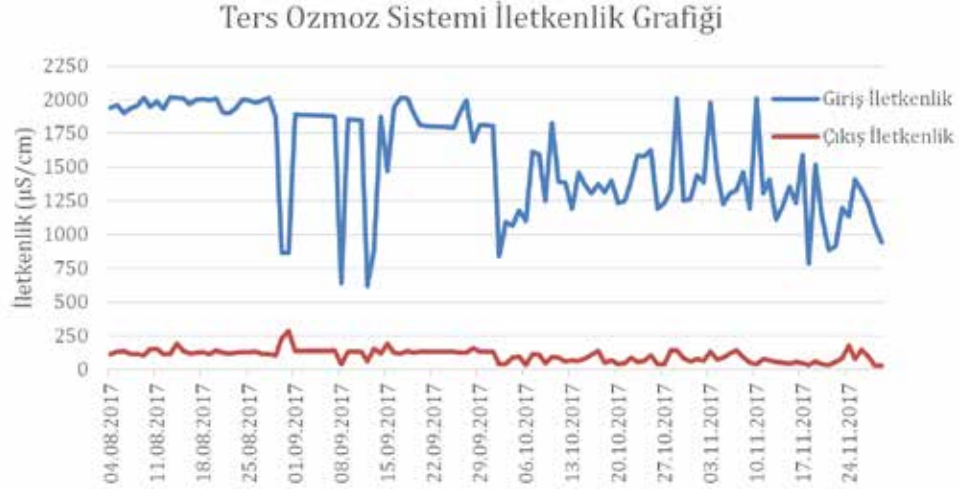
Şekil 8. Ambarlı TO sistemi giriş ve çıkış iletkenlik değerleri
