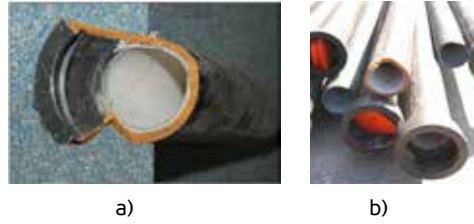
Şekil 3. Muf ayrılmasına örnekler, a) Borunun muf kısmı tamamen ayrılmış ve boruda bir miktar ovalleşme mevcut, b) Boru muf tarafından kırılmış, muf tamamen boru bün-yesinden ayrılmamış.
