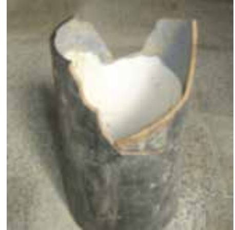
Şekil 6. Spiral kırılmaya örnek boru resmi
