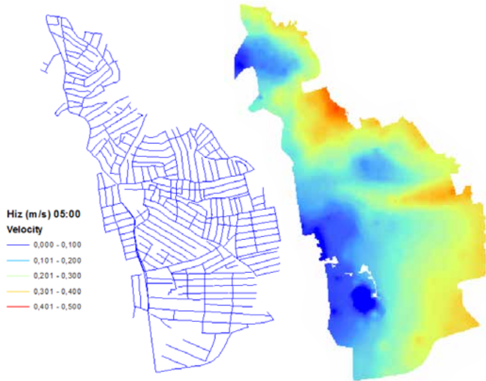
Şekil 3. Su dağıtım sisteminde hız ve basınçların dağılımları
