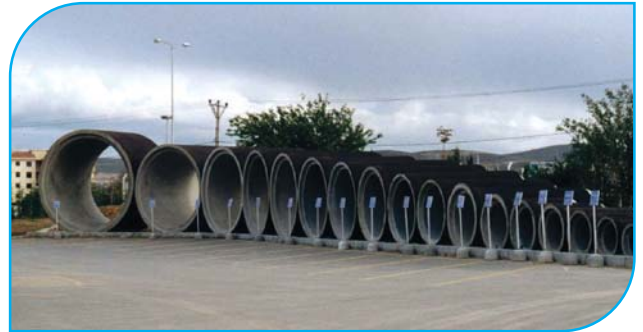
200mm.-Ø3600mm. ÇAPLARI ARASINDA ÜRETİLEN BETON - BETONARME BORULAR
